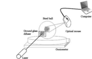
Figura 6. Método experimental sobre el movimiento artificial de un ojo causado por una rotación horizontal de un go-niómetro [13].
