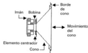
Figura 2. Altavoz dinámico de imán permanente [12].
