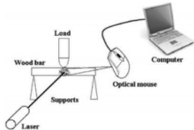
Figura 5. Método experimental de un desplazamiento de una barra de madera causada por una carga [13].
