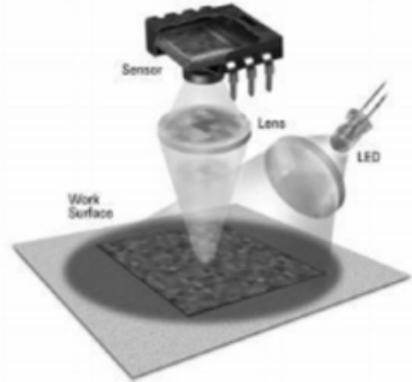
Figura 1. Los mouses ópticos iluminan un parte de la superficie de trabajo con un led, para poder así hacer su propio patrón de sombras y reflejos.
